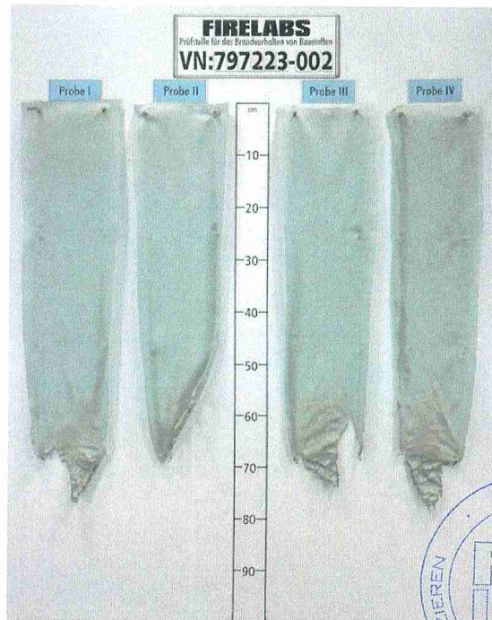
Bild 4 Aussehen des Probekörpers nach dem Brandversuch
