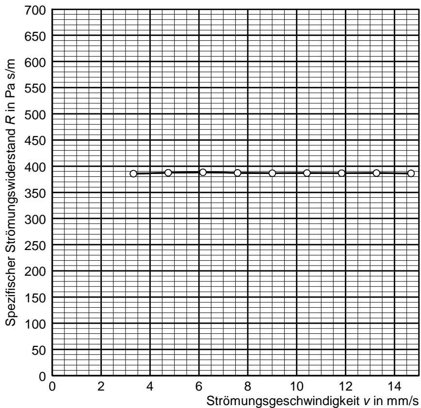
Spezifischer Strömungswiderstand  $R_s = 388 \text{ Pa s/m}$
