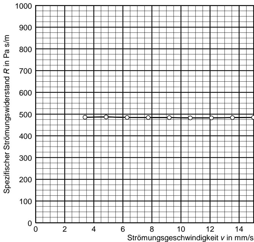
Spezifischer Strömungswiderstand  $R_s = 487 \text{ Pa s/m}$
